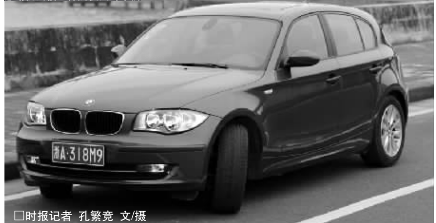
试驾车型:宝马120iAT 排量:2.0L 最大功率:156马力/6400转 最大扭矩:200牛米/3600转 自重1.375吨 轴距:2.66米 亮点:DSC动态稳定控制系统 售价:28.8万元 感谢杭州骏宝行提供试驾车辆
